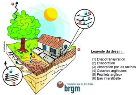
Le phénomène de retrait-gonflement des argiles est issu d’un matériau argileux qui voit sa consistance se modifier en fonction de sa teneur en eau : dur et cassant lorsqu’il est desséché, il devient plastique et malléable à partir d’un certain niveau d’humidité. Ces modifications de consistance s’accompagnent de variations de volume, dont l’amplitude peut être parfois spectaculaire.
